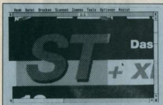
Durch Amplitudenmodulation kann bei Marvin aus dem geometrischen ein Zeitungsraster errechnet werden
